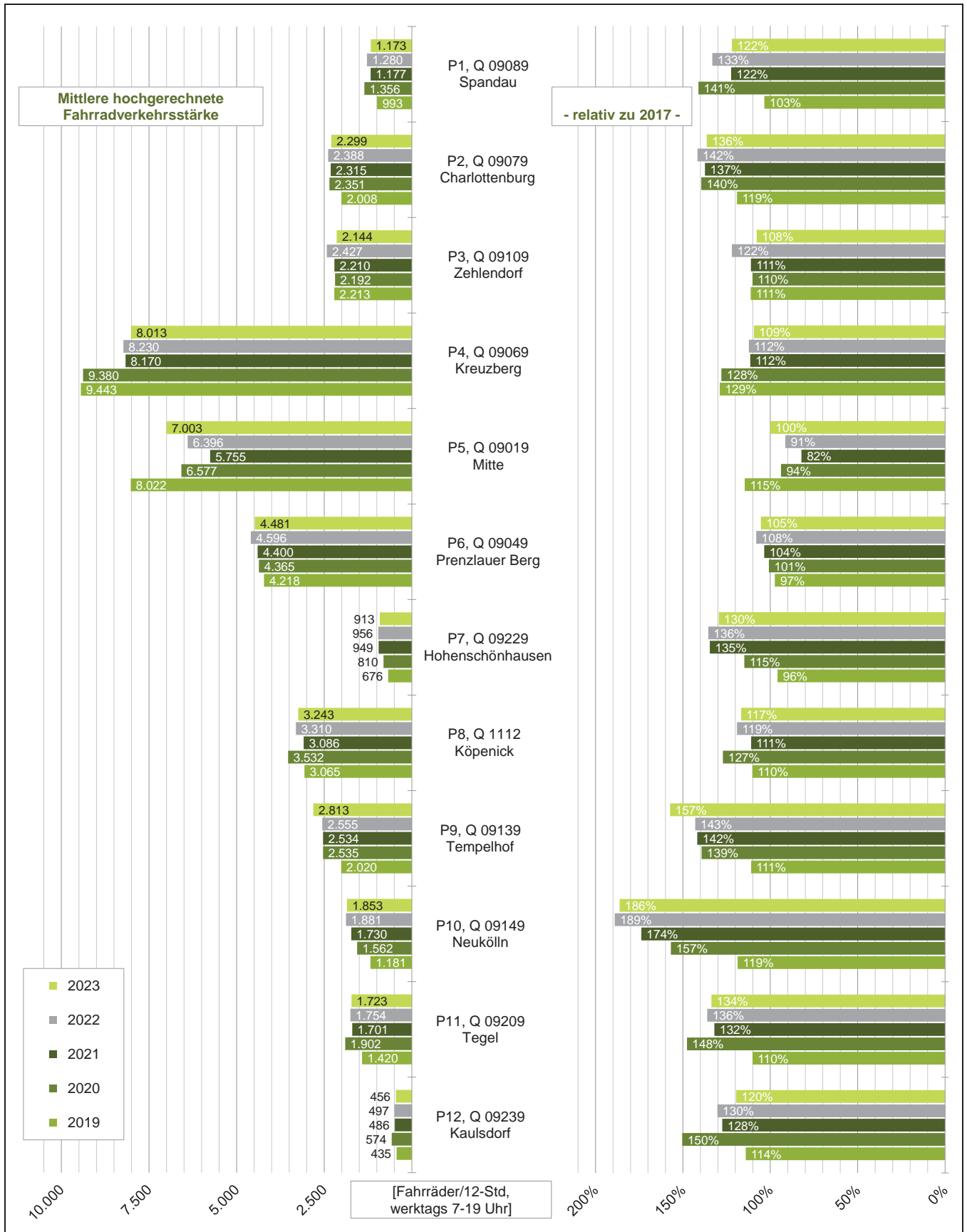
Abbildung 9: Werttägliche hochgerechnete Fahrradverkehrsstärken der Pegelpunkte 2019 bis 2023 im Mittel und relativ zum Bezugsjahr 2017 [Fahrräder/12-Std, werktags 7-19 Uhr, beide Querschnitte und Richtungen zusammen]
