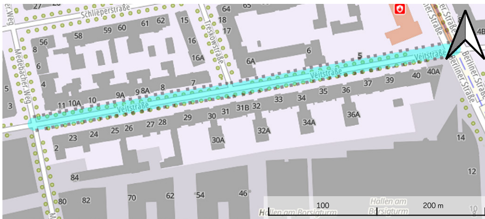
Abbildung 17: Lärmarme Fahrbahnoberfläche auf der Veitstraße (türkise Markierung)
