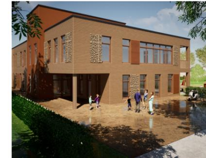
2 Für die Kita Havelländer Ring dienen Holz und Schafswolle als Bau- bzw. Dämmmaterialien. Das Dach wird als Gründach konzipiert. Neben Fernwärme kommt eine Photovoltaik-Anlage für die Energiegewinnung zum Einsatz.
