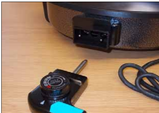
Abbildung 6.1.2: Elektrische Anschlüsse der Elektropfanne
