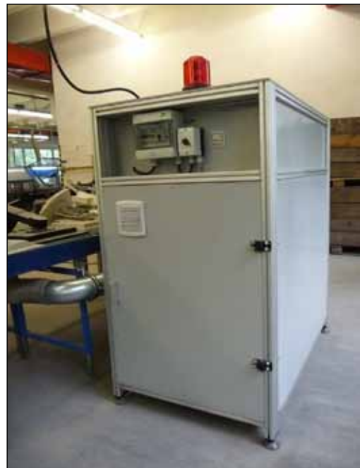
Abbildung 3.4.2: Absaugbox mit Warnleuchte und Spezialfilter
