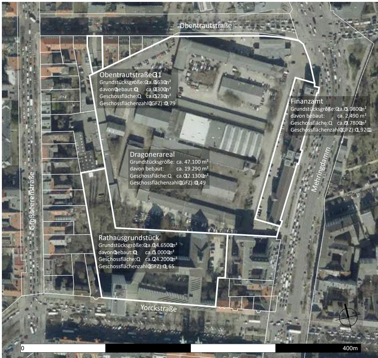
Abb. 4: Lage und Flächenangaben des Dragonerareals und angrenzender Grundstücke, Luftbildquelle: Geoportal Berlin, Digitale farbige Orthofotos 2017 (DOP20RGB); Grenzen: Automatisiertes Liegenschaftskataster; Einzeichnungen der Grundstücke: Eigene Darstellung
