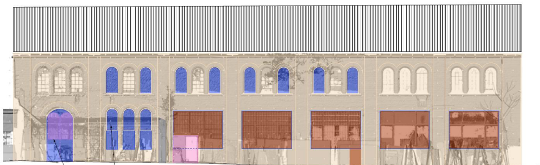
Abb. 24 Alte Reithalle, Ansicht Nord mit Kartierung der Bauepochen (Auszug Denkmalpflegeplan, 2020)
