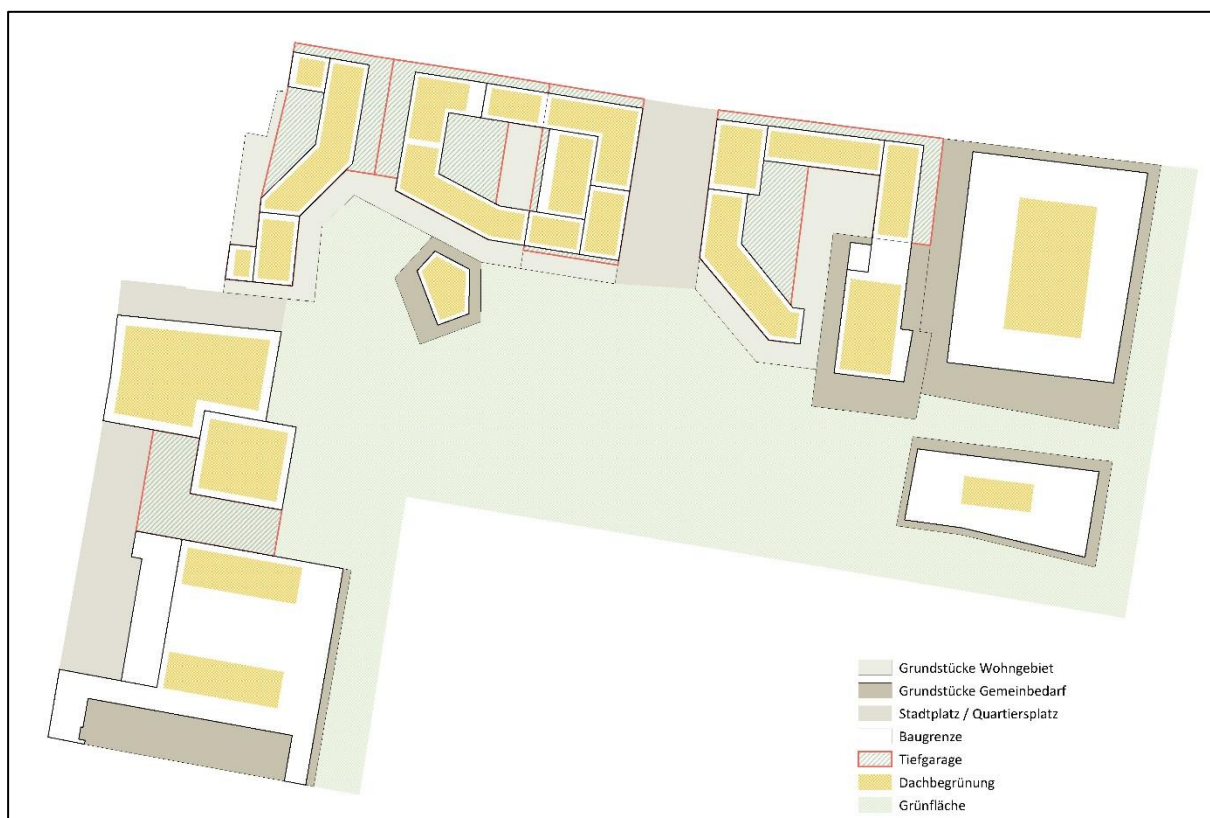
Abbildung 19: Übersicht Grundstücksflächen und Baugrenzen laut B-Plan; Tiefgaragen und Dachbegrünung nach eigenen Annahmen [Quelle: bgmr Landschaftsarchitekten GmbH 2022]
