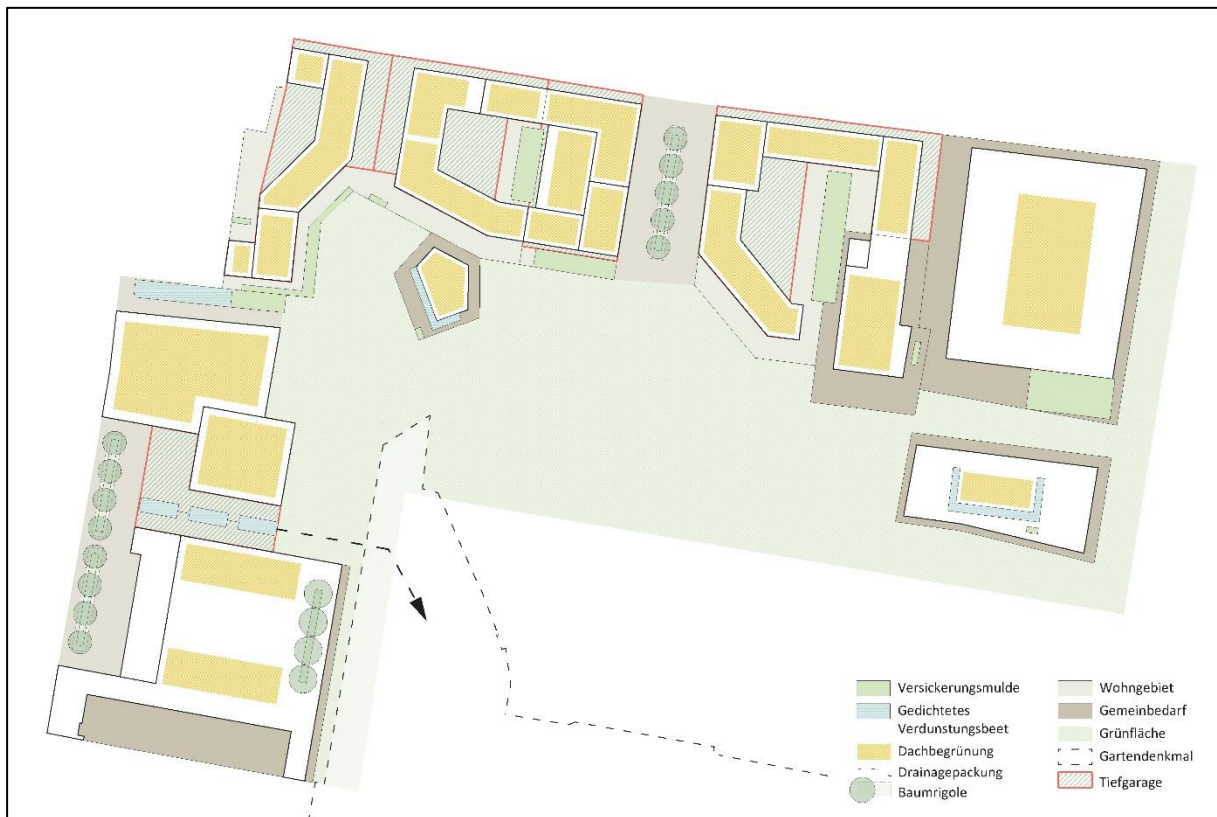
Abbildung 28 Regenwasserkonzept mit Flächenbedarfen der dezentralen Regenwasserbewirtschaftung (maßstäblich), Variante mit Tiefgarage am Stadtplatz wie im B-Plan Entwurf und Verdunstungsbeeten [Quelle: bgmr Landschaftsarchitekten GmbH 2022]
