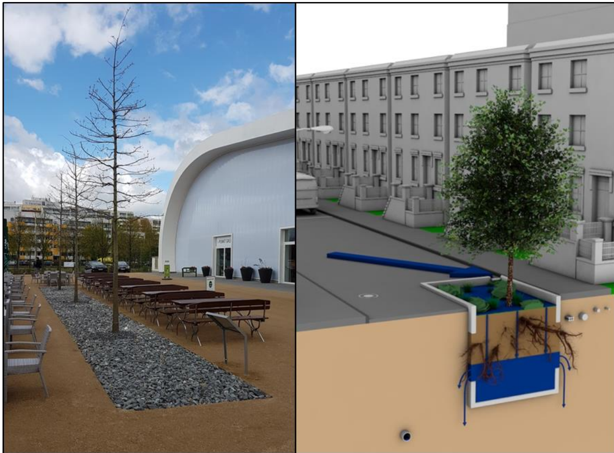
Abbildung 34: Baum-Rigole in den Gärten der Welt (links) und Konzeptdarstellung (rechts) [Quelle: Ingenieurgesellschaft Prof. Dr. Sieker mbH 2019]
