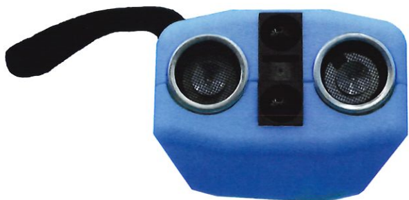
Bildbeschreibung zum Foto oben: Die Vorderseite der Fledermaus mit den Infrarot- und Ultraschall-Sensoren.
