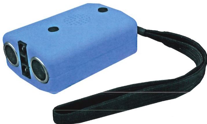
Bildbeschreibung zum Foto oben. Die Fledermaus liegt in Drei-Viertel-Ansicht, so dass man deutlich die beiden Taster und die Sensoren an der Vorderseite sowie die Handschleufe an der Rückseite sehen kann.
