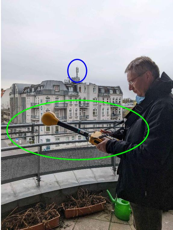
Bild A1: Messpunkt DSS\_1 mit Mobilfunkanlage
