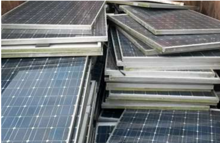
Abbildung 29 Nicht mehr gebrauchsfähige PV-Module.
