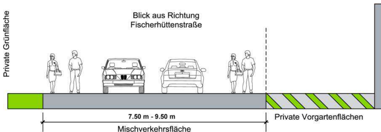
Abbildung 23b Privatstraße Fläche „a“, Blick aus Richtung Fischerhüttenstraße
