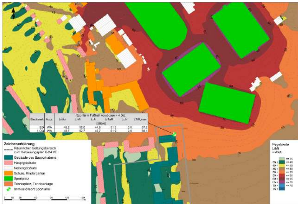
Abbildung 15b Schallimmissionsplan für Sportlärm – Beurteilungspegel innerhalb der mittäglichen Ruhezeit an Sonn- und Feiertagen (worst-case)
