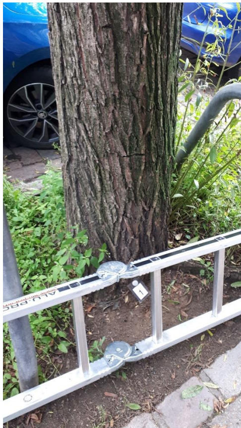
links Messpunkt 1 IML-Resi, westlicher Stammfuß
