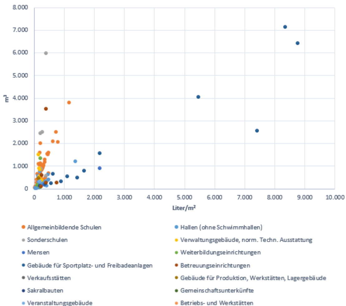
Abbildung 49: Absolute und relative Wasserverbräuche der Gebäude 2018
