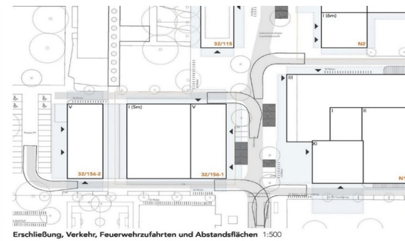
Abb. 9: Städtebauliches Gutachterverfahren Gebietszentrum Siedlung Jungfernhöhe (Phase 3): Erschließungs- und Abstandsplan (Ausschnitt), Stand: 09.2020 Quelle: Studio Schultz Granberg + bbz Landschaftsarchitekten
