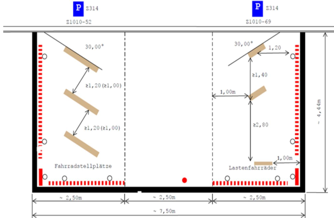
■ Rahmenmarkierung entsprechend RP101, Schmalstrich Z295 (Nur bei Asphaltdecke)
