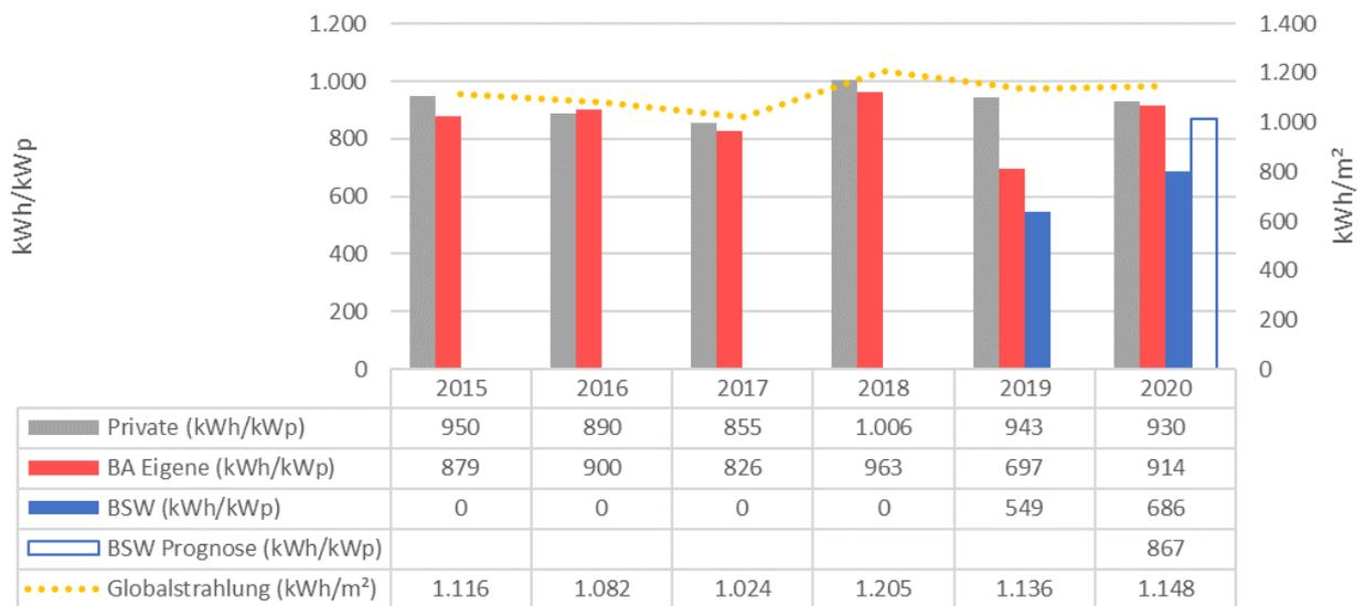
Abbildung 9: Spezifische Stromerzeugung der PV-Anlagen
